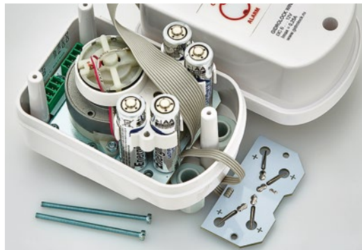
Фото 31. Контактная площадка снята, батарейки могут быть заменены
